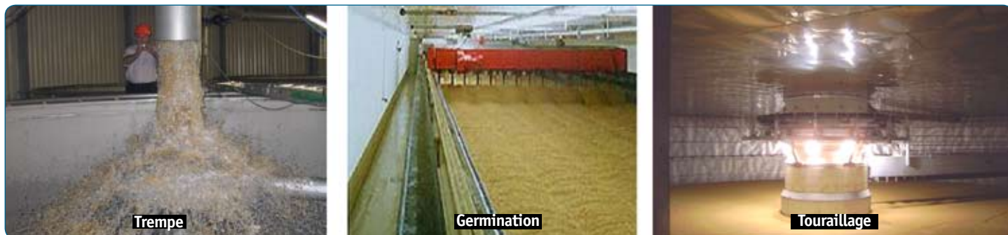
Figure 1 : Les différentes étapes de la transformation de l'orge en malt.
